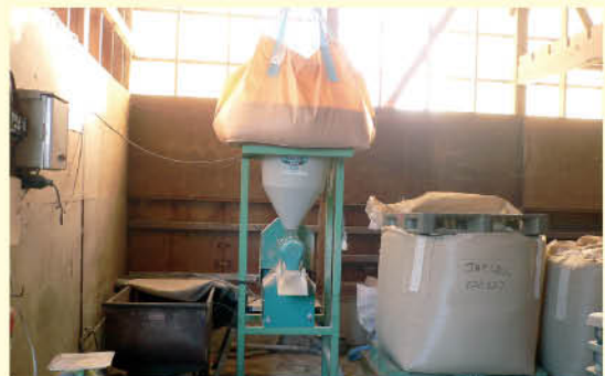
④ 飼料米破砕機 (牛が食べやすいように飼料米を細かく砕きます。)
