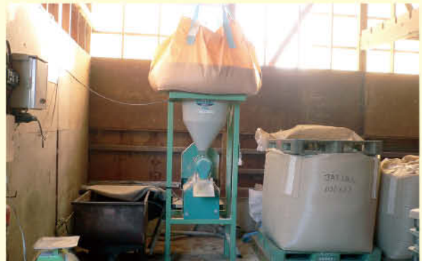
飼料用米破砕機 (牛が食べやすいように飼料用米を細かくできます。)
