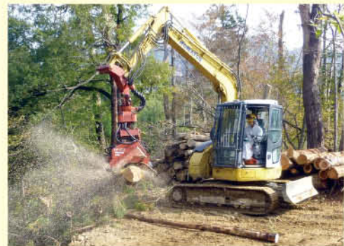
⬇ ②プロセッサ ・切った木をつかんで えだ 枝を切り落とす ・木を一定の長さ へい に切って丸太にする ・切った木や丸太をつかんで一か所に集める
