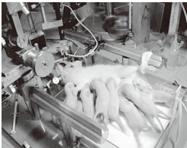
授乳期のラットを麻酔下で脳定位固定装置に固定し、子ラットによる吸入刺激を加えて乳汁射出反射を起こしオキシトシン細胞の電気活動と乳腺内圧を計測。写真は今までに射乳が起こっている瞬間であり、子ラットは体をピンと伸ばしている。
