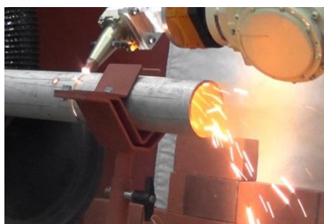
ふげん等での機器切断試験
