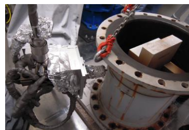
ふげん等での機器切断試験
