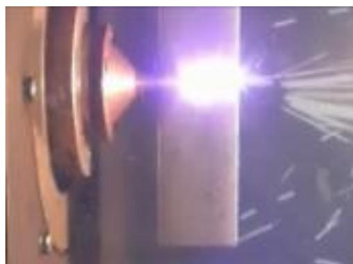
レーザー厚板切断要素技術開発 (気中切断)
