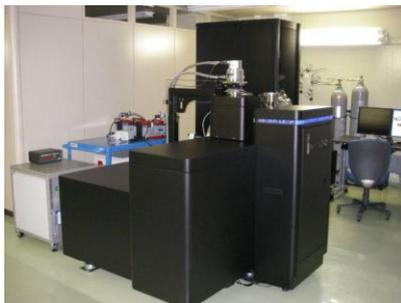
原子プローブ電界イオン顕微鏡
