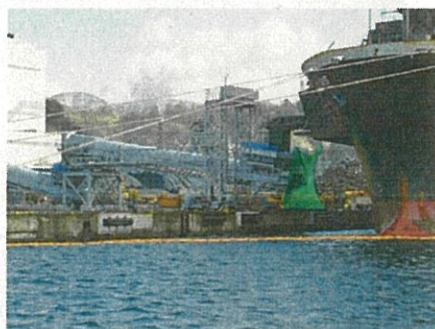
木質チップ船からベルトコンベアにチップを下している状況
