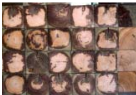
防腐剤(ACQ)の浸透状態
