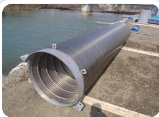
巻線型SUSスクリーン管。この管は周囲に細かい隙間があり、その隙間から伏流水を取水します。
