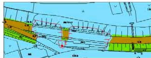
図-3.3.15 足羽川における破堤進行状況想定図
