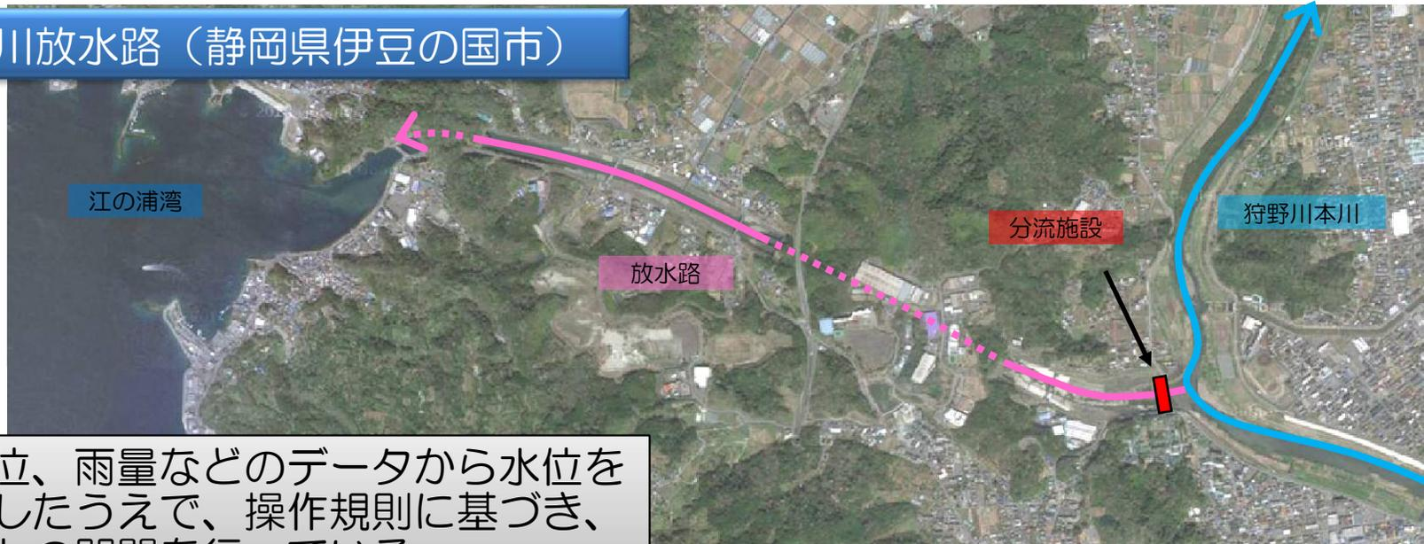
水位、雨量などのデータから水位を予測したうえで、操作規則に基づき、ゲートの開閉を行っている。
