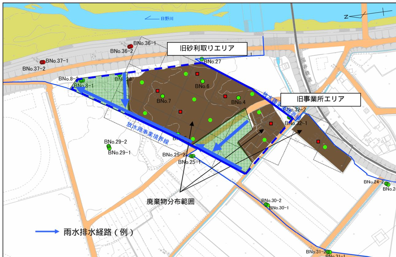
図 4.5 雨水排水計画平面図(例)
