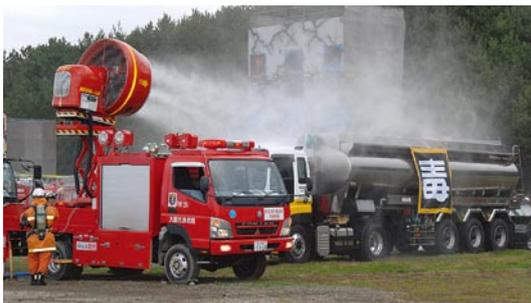
大型ブローアークによる漏洩物拡散処理
