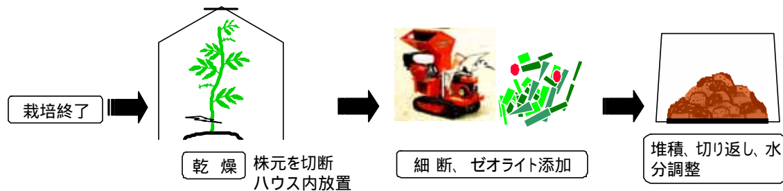
第7図 人工ゼオライトを利用したトマト残渣堆肥化の手順
