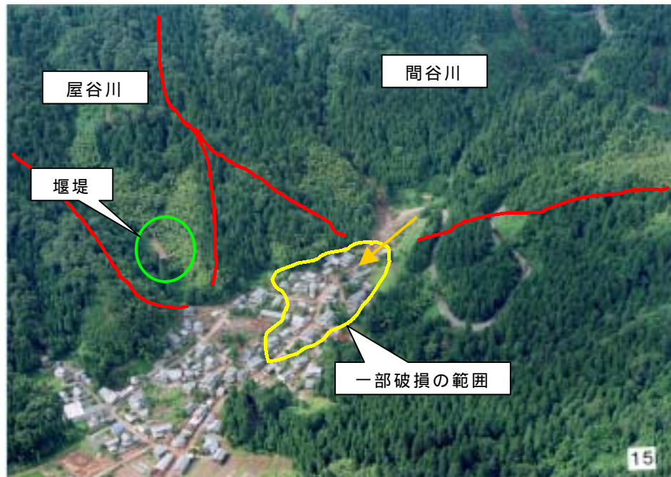
一つの集落で堰堤の有無が土石流の被害を分けた例
