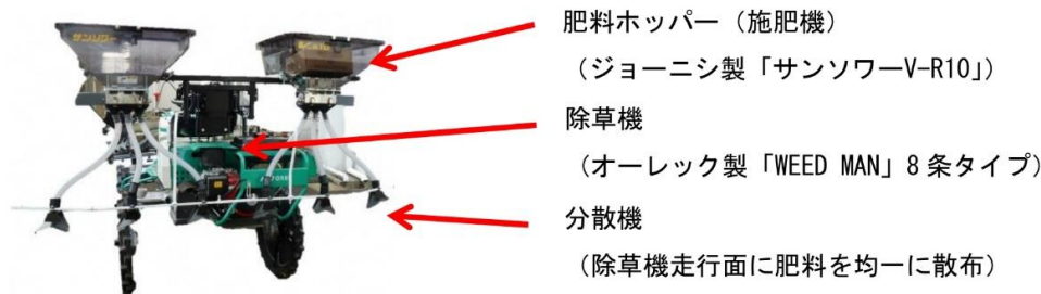
写真1 開発したペレット散布機付き除草機(後方から撮影)
