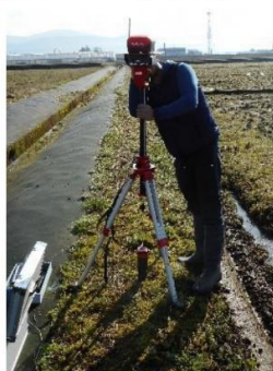
図2 地上基地局設置の様子
