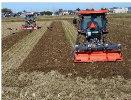
図1 同一圃場で2台のトラクタで協調作業（耕うん）
