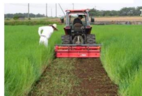
写真2 改良ロータリでの緑肥のすき込み
