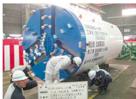
④ 鉄の歯を回転させて地面の下を掘る
