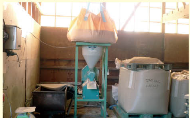
↑ しりょう まい は さい 飼料用米破砕機 (牛が食べやすいように飼料用米を細かくできます。)
