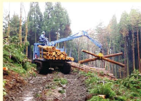
⬇ ③フォワーダ ・丸太をつかんで荷台に かみ 積み込む ・丸太を運ぶ
