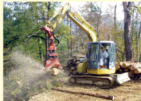
⬇ ②プロセッサ ・切った木をつかんで えだ 枝を切り落とす ・木を一定の長さ ながさ に切って丸太にする ・切った木や丸太をつかんで一か所に集める
