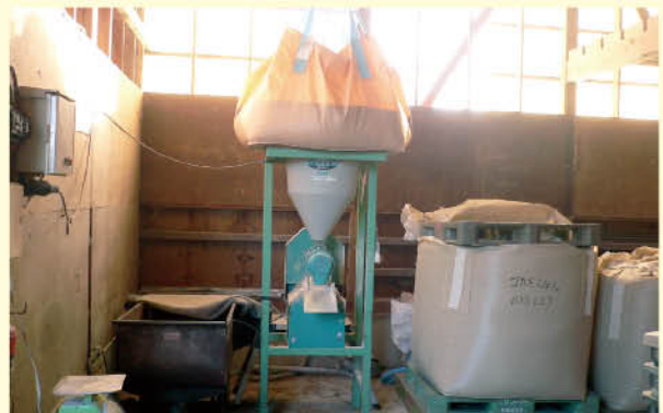
⬆️ しりょうまいほさい 飼料用米破砕機 (牛が食べやすいように飼料用米を細かくできます。)
