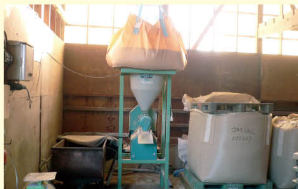
飼料用米破砕機 (牛が食べやすいように飼料用米を細かくできます。)
