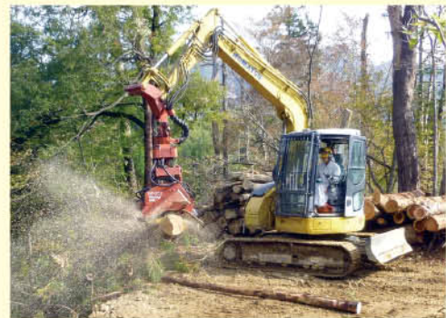
⬇ ②プロセッサ ・切った木をつかんで えだ 枝を切り落とす ・木を一定の長さに切って丸太にする ・切った木や丸太をつかんで一か所に集める
