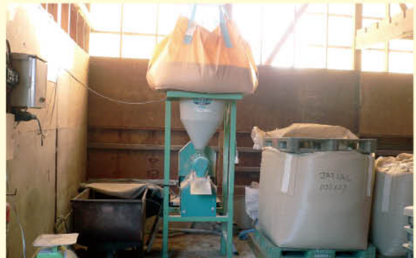
飼料用米破砕機 (飼料用米を牛が食べやすいように細かくできます。)
