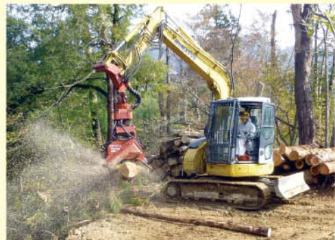
⬇ ②プロセッサ ・伐った木をつかんで えだ 枝を伐り落とす ・木を一定の長さに伐って丸太にする ・伐った木や丸太をつかんで一か所に集める
