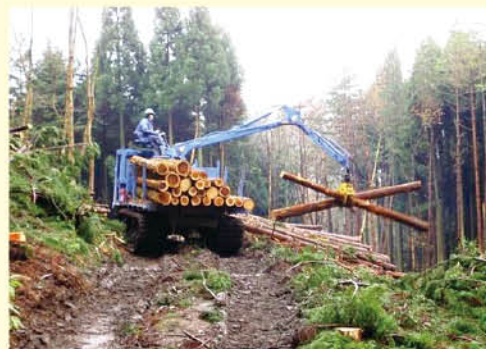
⬇ ③フォワーダ ・丸太をつかんで荷台に積み込む ・丸太を運ぶ
