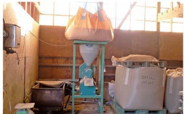
📍 飼料用米破碎機 (飼料米を牛が食べやすいように細かくできます。)
