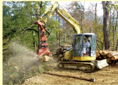
ⓘ ②プロセッサ ・伐った木をつかんで枝を伐り落とす ・木を一定の長さに伐って丸太にする ・伐った木や丸太をつかんで一か所に集める
