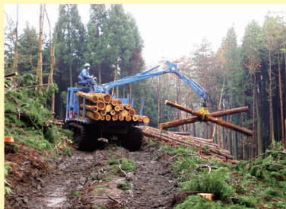
⬆ ③フォワーダ ・丸太をつかんで荷台に積み込む ・丸太を運ぶ
