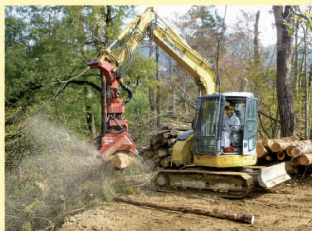
⬆ ②プロセッサ ・伐った木をつかんで枝を伐り落とす ・木を一定の長さに伐って丸太にする ・伐った木や丸太をつかんで一か所に集める
