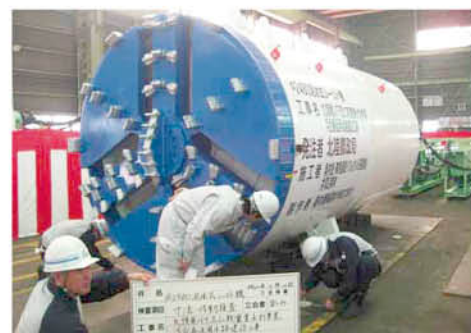
Ⓛ 鉄の歯を回転させて地面の下を掘る
