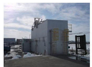
写真1 真空・高温乾燥機 減圧効果により低温域での乾燥が可能で、色や香りなど天然乾燥に近く仕上がる
