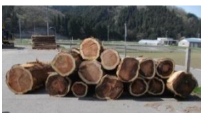
写真2 試験用丸太（φ35～47 cm）
