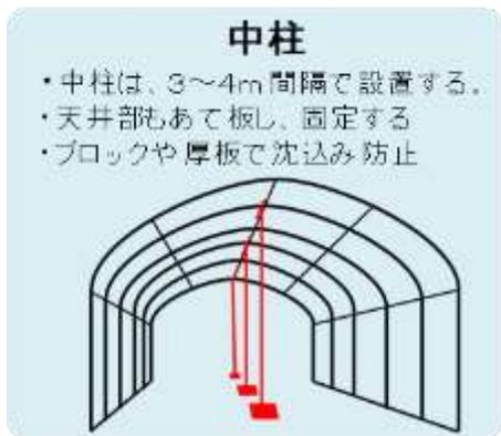
図16 中柱による補強と設置例
