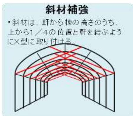
図11 斜材(X型)による補強
