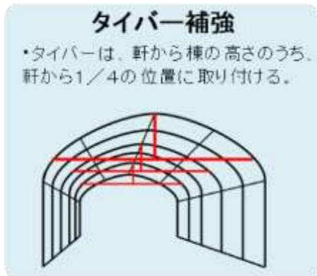
図10 タイバーによる補強(逆T字型、ツカ2本のタイプ)
