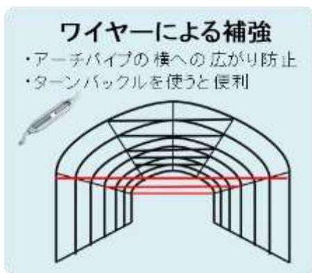
図13 ワイヤーによる補強
