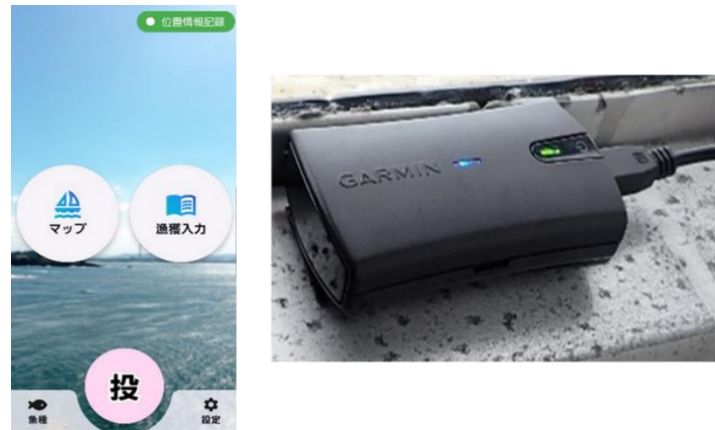
図2 スマホ版電子操業日誌の概要 (左図：今年度開発したアプリケーション画面、右図：GPS アンテナ)
