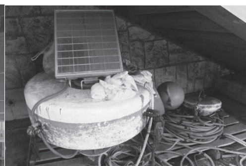
図5 米神定置網に設置されていた魚群探知機と送信システム （左：アンテナ、上：電源と魚群探知機）
