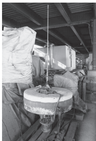
図5 米神定置網に設置されていた魚群探知機と送信システム （左：アンテナ、上：電源と魚群探知機）
