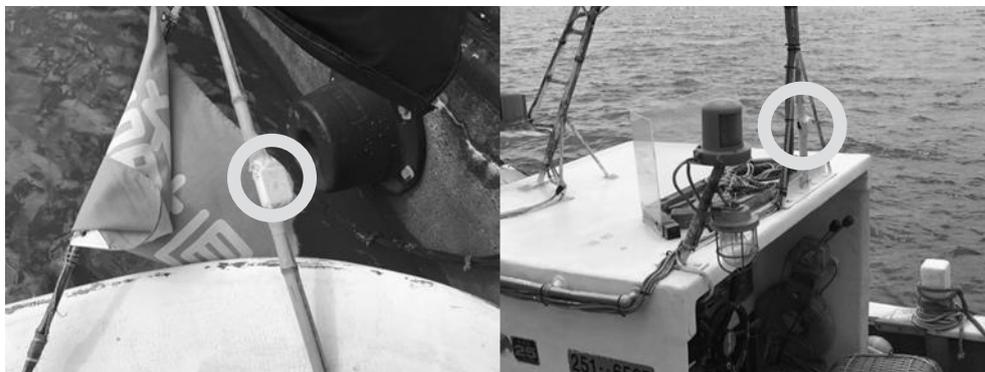
写真2 GPS を取り付けた様子 左は旗竿、右は船体に取り付けた様子。
