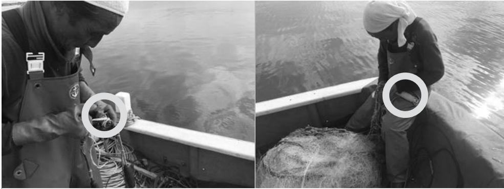
写真1 深度計を取り付ける様子 左は浮子側、右は沈子側に取り付ける様子。
