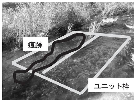
図11 平成29年度 St.2改良型ユニットにおける河床痕跡
