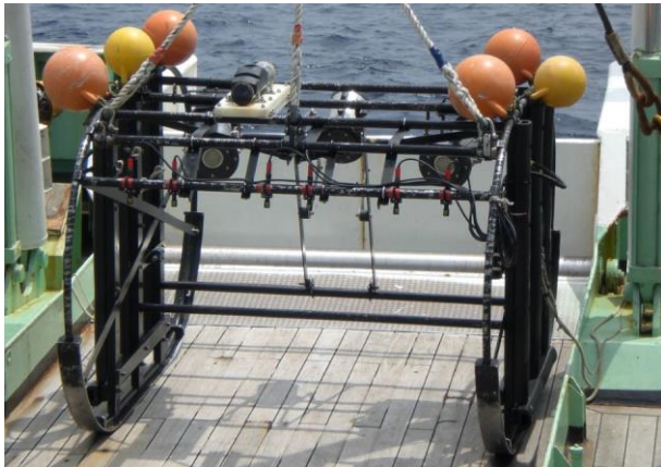
写真1 撮影機器類（曳航枠・カメラ・ライト）
