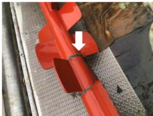
図8 引き揚げた耕耘機の耕耘部に絡みつく鉛付きロープ
