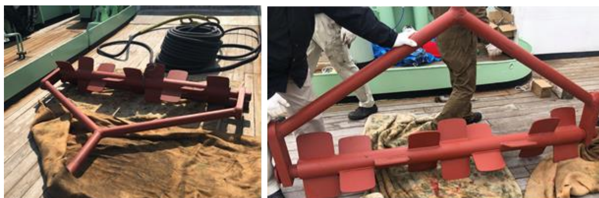
図6 耕耘機の外観（左：前方から撮影、右：耕耘部を撮影）
