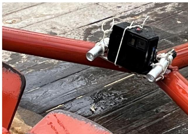
図5 海底耕耘機にカメラ装着 (GoPro8 と水中ライト)
