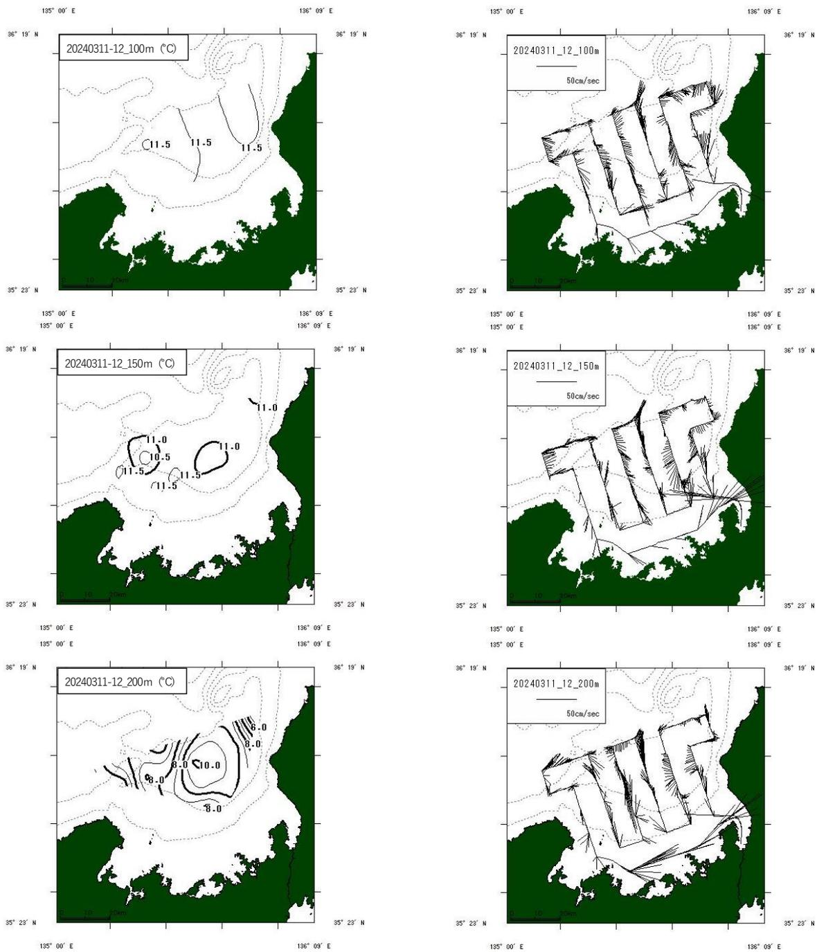
図2-6 若狭湾海域水温および流向・流速水平分布（令和6年3月11日~12日）
