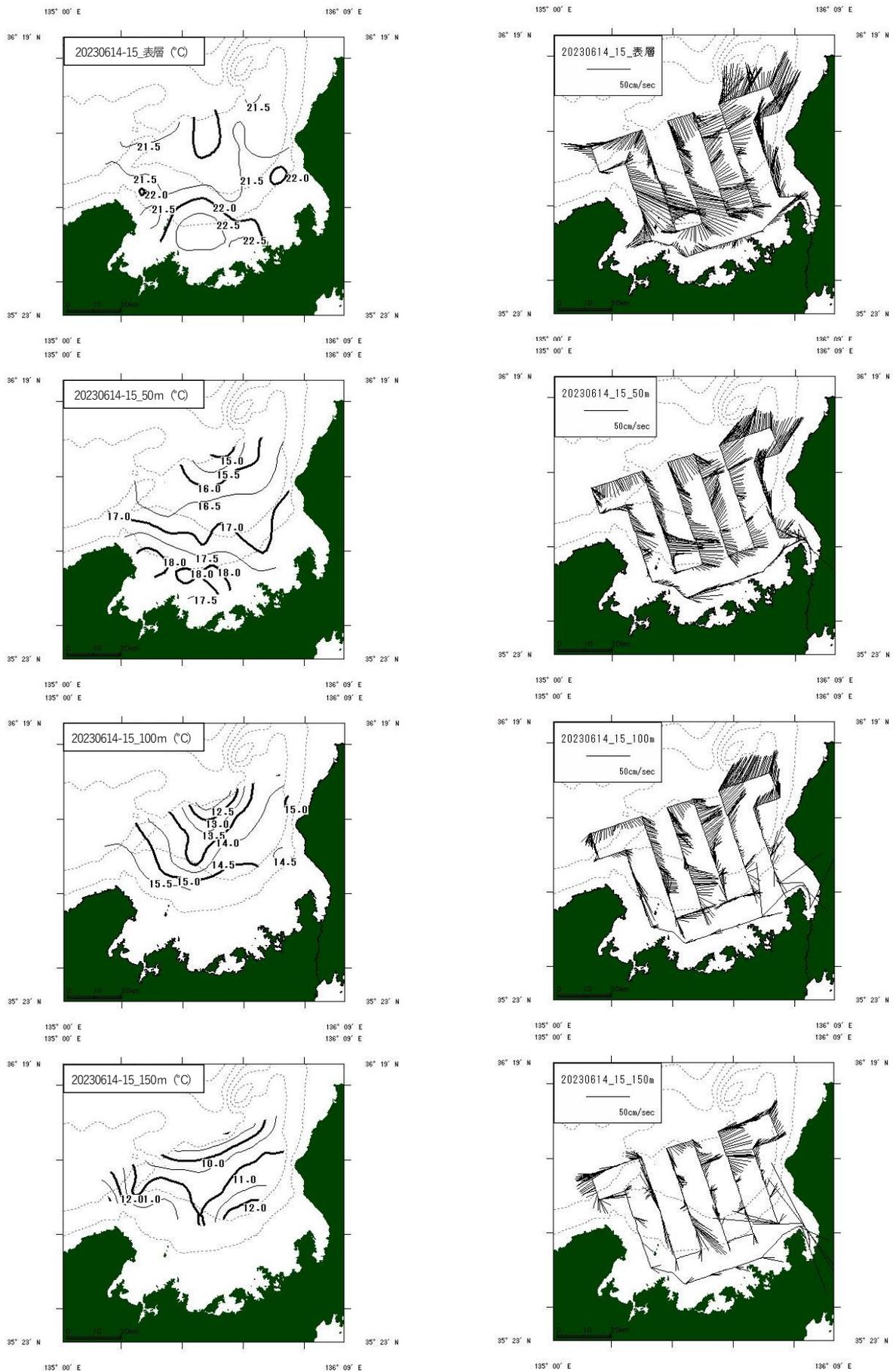
図2-2 若狭湾海域水温および流向・流速水平分布（令和5年6月14日～15日）
