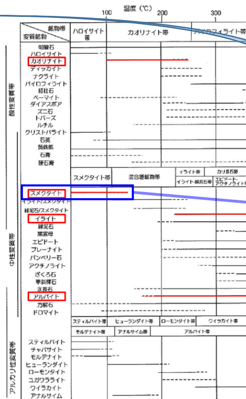
図9 各変質帯に特徴的な鉱物とそれらの概略の生成温度(吉村(2001)を改変)。
