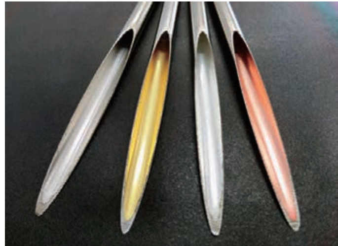
撥水性 / 摺動性 / 離型性に優れた Ni-PTFE 複合めっき被膜
