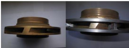
写真2 羽根の加工前 (左) と後 (右)
