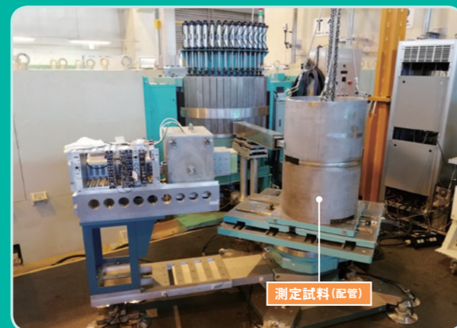
配管溶接部のひずみ測定 [資料提供: 日本原子力研究開発機構]
