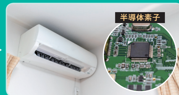
エアコンのインバーターなどに使われるパワー半導体
