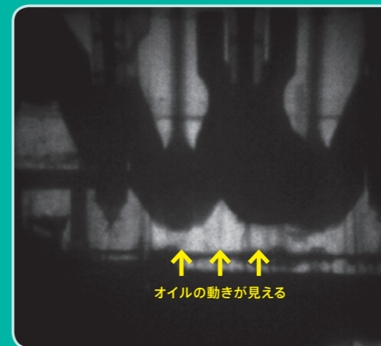
エンジン内部の潤滑油の動きを評価するために中性子ビームにより高速で可視化しています。 [資料提供: 日本原子力研究開発機構]
