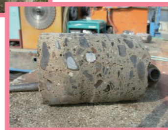
コア抜きしたコンクリート表面から1cm間隔で試料を採取
