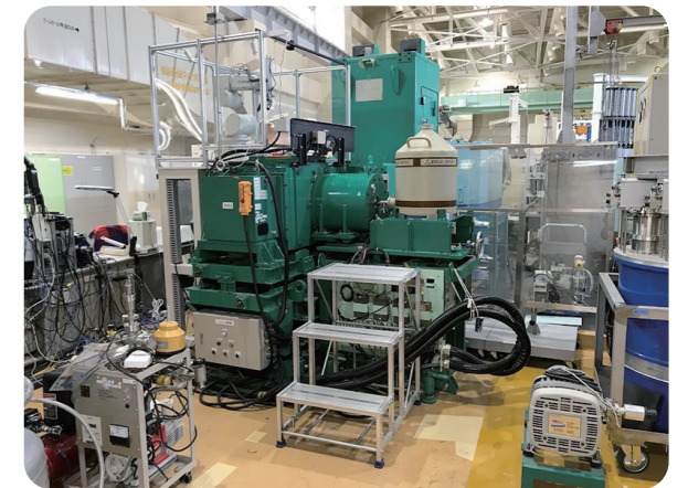
即発γ線分析装置 写真提供: 日本原子力研究開発機構
