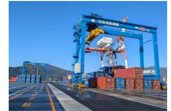
トランスファークレーン (R7.1月～本格稼働開始)
