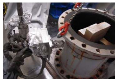
ふげん等での機器切断試験
