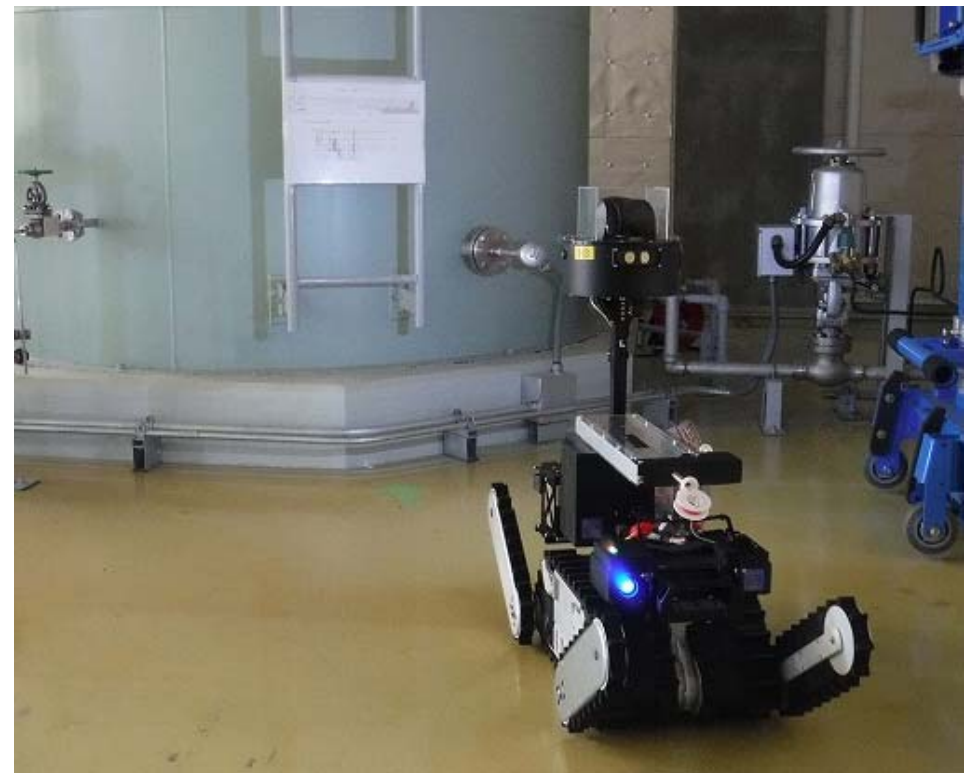
使用済み燃料プールの水位監視を想定した パラメーター監視
