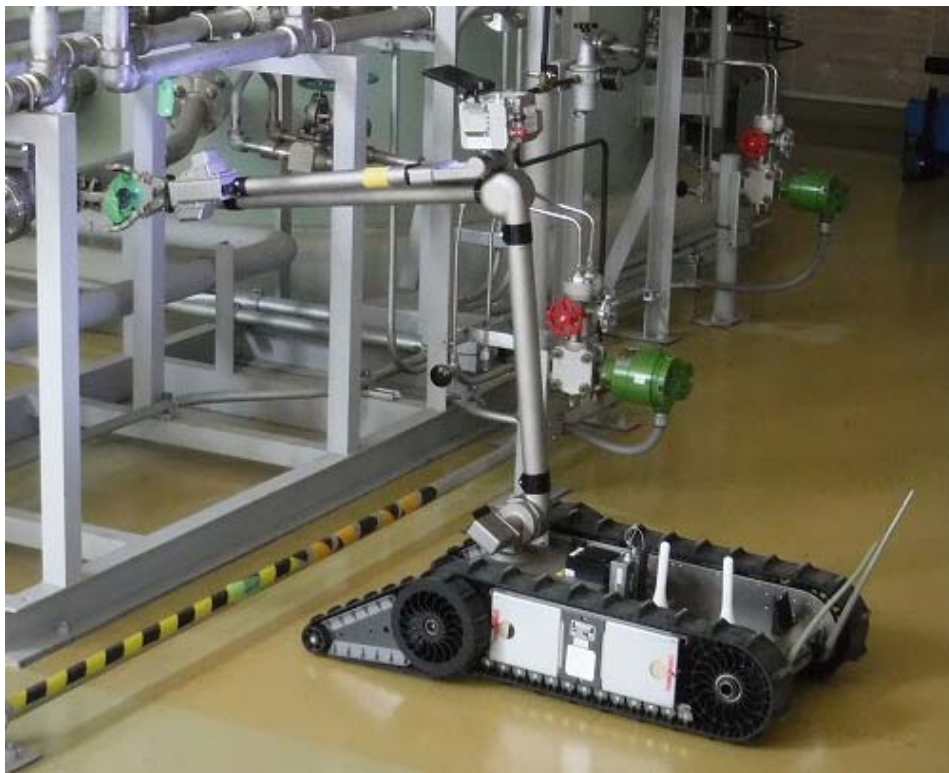
操作ロボットによる扉開閉を模擬した弁操作
