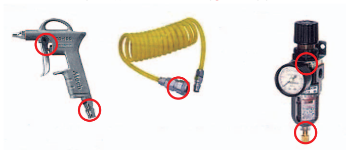
〈エア漏れしやすい箇所（○の囲み）〉
