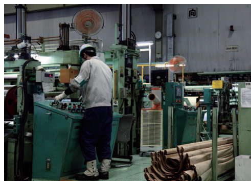
〈スポット空調の使用状況〉
