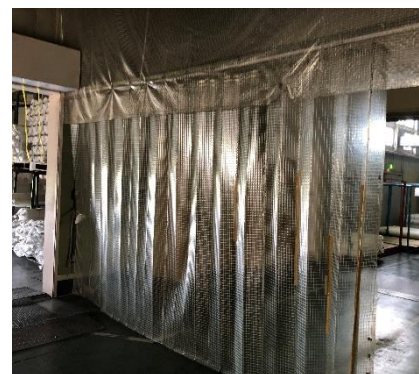
↑ ビニールカーテン
