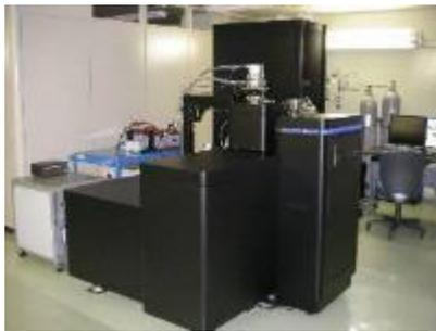
原子プローブ電界イオン顕微鏡
