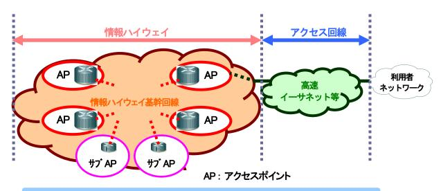
情報ハイウェイは、「基幹回線」および「アクセスポイント」で構成される
