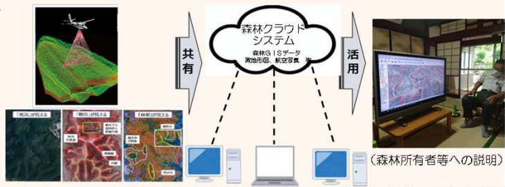
【航空レーザ計測による地形・資源のデジタル化】 【クラウドによるデータ共有】 【アプリによるデータ活用】 （森林所有者等への説明）
