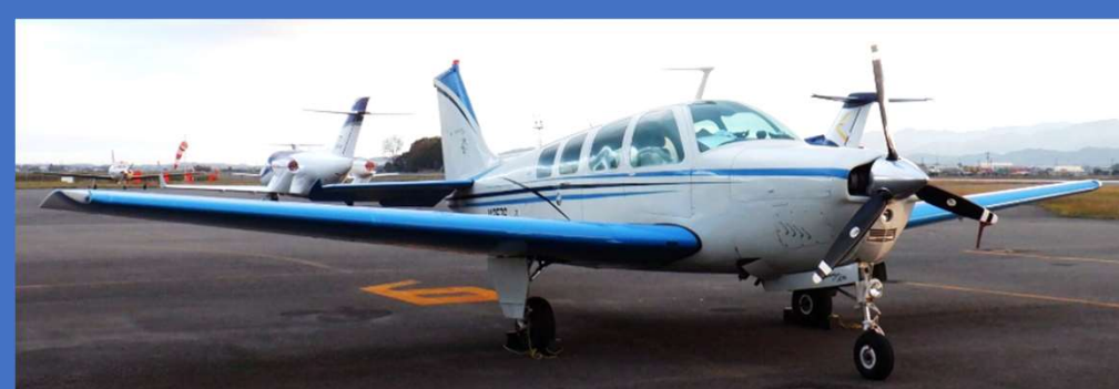
ビーチクラフト A36 ボナンザ 【熊本空港より】
