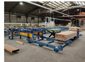
製材品の強度等を測定する機械
