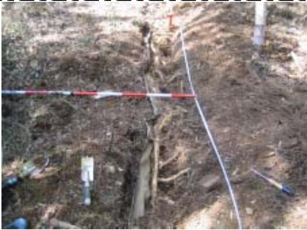
写真-1 防根シート試験区の防根効果
