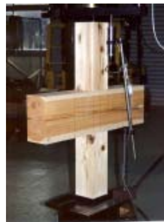
写真-3 材中間部の試験 (梁中間部で上下に柱がある場合を想定)
