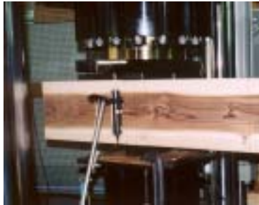
写真-1 材端部および材中間部めり込み試験（写真は材中間部試験）
