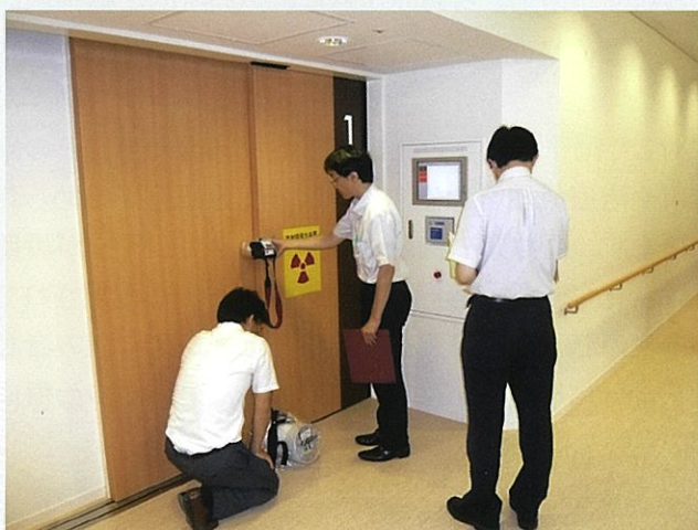
施設検査の様子。治療室扉前で放射線の漏れがないかを調べています。
