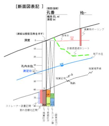
図-2.3.5 処分場付近の地質断面図（東西-中央・処分場南側・山側）
