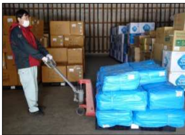
図5 ハンドリフトによる管理・運搬
